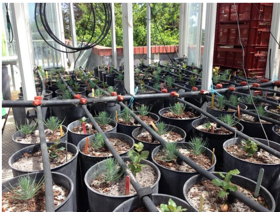
Figura 6 - Sistema de rega do ensaio na estufa.
